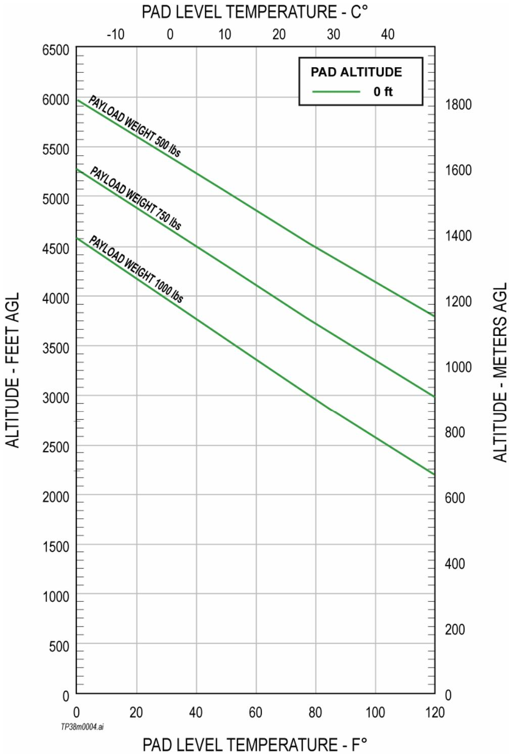
**OPERATING ALTITUDE AS A FUNCTION OF GROUND TEMPERATURE FOR A 38M AEROSTAT**
